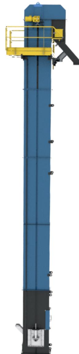
Elevatör kovaları yüksek ısı ve aşınma dayanımına sahiptir. Elevatörlerde özel dövme çelik zincirler kullanılmaktadır. Tamamen sızdırmaz gövdeye sahiplerdir. Kolaylıkla montaj yapılacak şekilde tasarlanılmışlardır. Elektrik kesintilerine önlem olarak geri dönüş kilitli redüktörler kullanılır. İlk veya yükte kaldırırmaya karşı önlem olarak da soft starter sistemi kullanılır.
